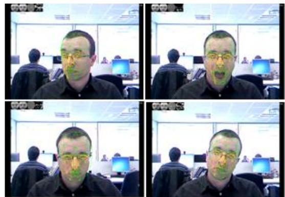
Fig. 4. Detección y modelado 3D de caras, con adaptación del template, ajuste de expresiones y seguimiento ante traslaciones, rotaciones y escalados
